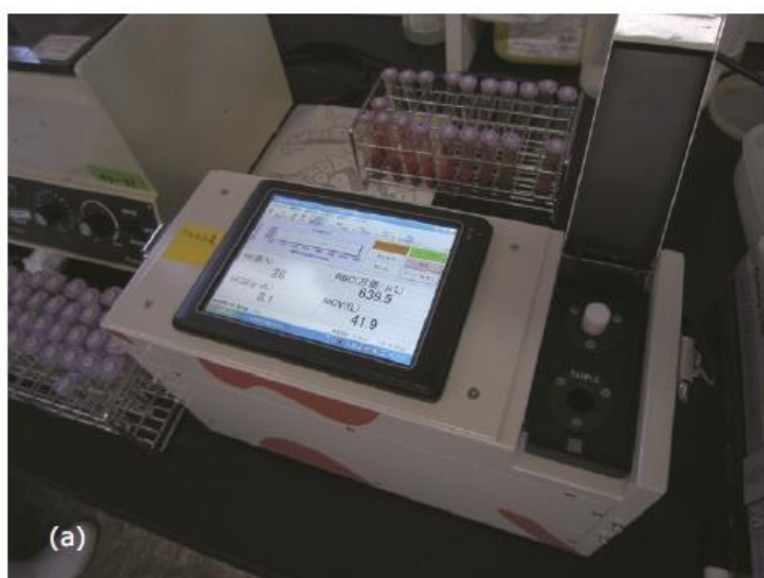
図 124 近赤外分光による牛血液測定装置と採血管 144)
