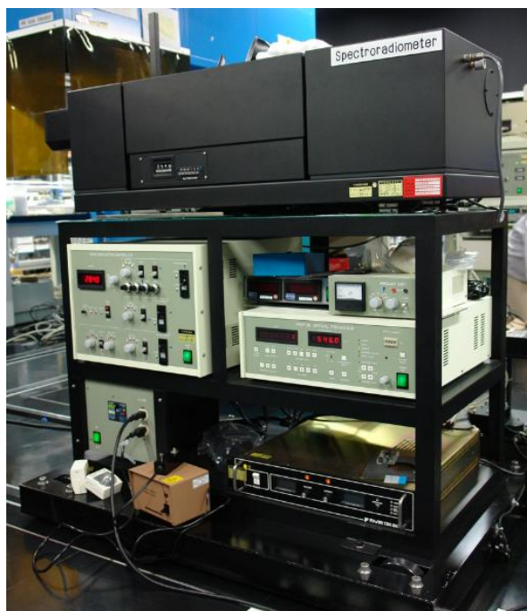
図 70 OSMO504 型分光放射計 (宇宙航空研究開発機構殿保有)
