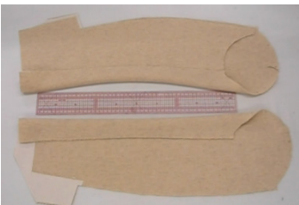
図7-4: くせとり処理を行った袖(上)と行わない袖(下)
