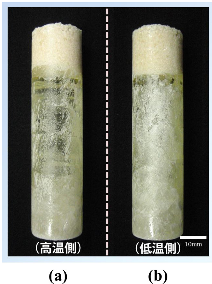
図 3-10 傾斜温度分布を利用した LLNbO 単結晶育成結果
