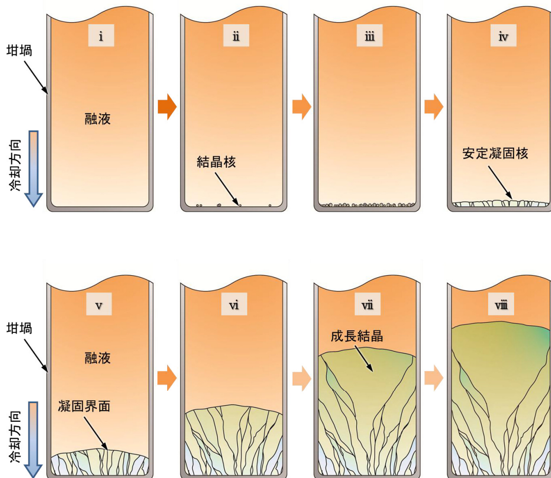
図 3-8 一方向凝固による単結晶成長過程の模式図
