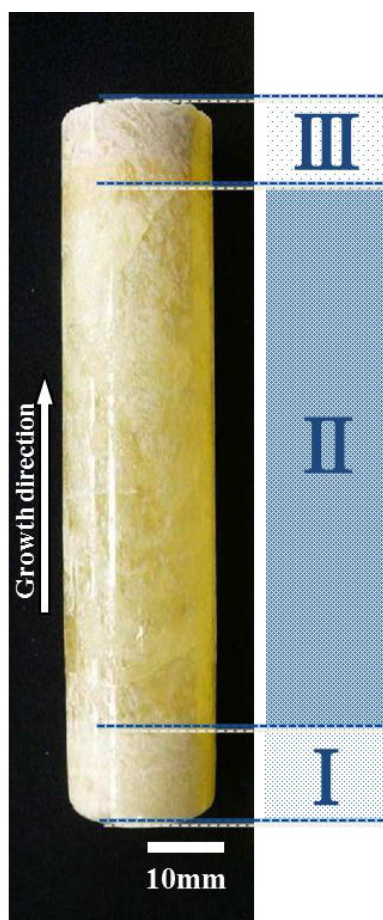
図 3-6 融解後 12 時間加熱保持後に育成開始して得られた LLNbO 結晶インゴットの状態
