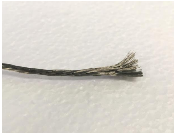
図2.13 磁性めっき線を用いたリッツ線の外観
