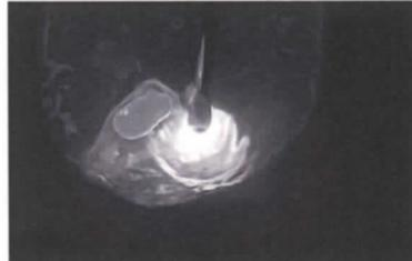
図3 溶滴の飛散
