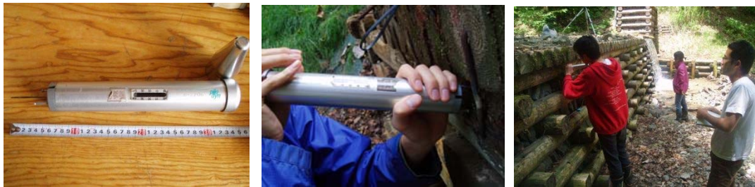
図 - 3. 2 ピロディンと貫入量調査の様子
