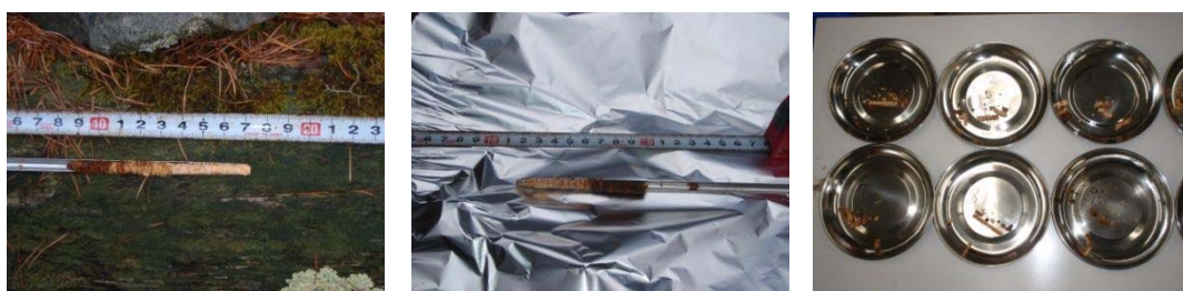
図 - 8. 6 内山３（９年経過）の成長錐コアの様子（全乾前）
