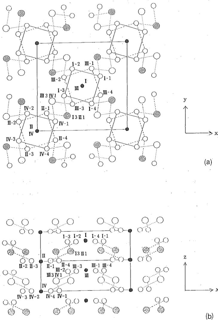
Fig. 1. Crystal structure of  $\text{Bi}_2\text{CuO}_4$ . ● : Cu; ○ : O; ○, ⊙ : Bi
