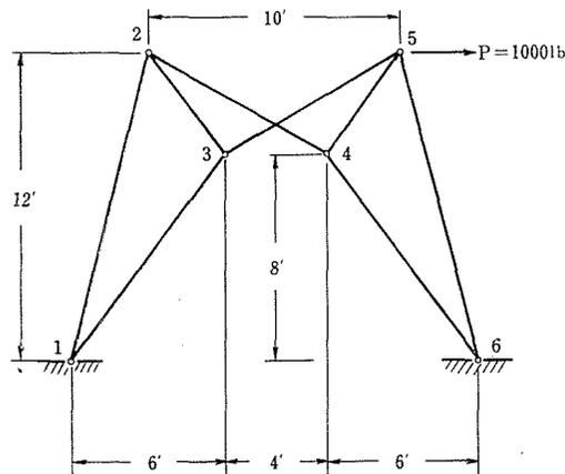
Fig. 7. Plane Truss
