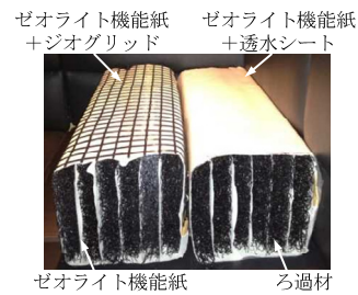
(a)農業用水路やU字溝のための浄化ユニット(15×15×50cm@2個)
