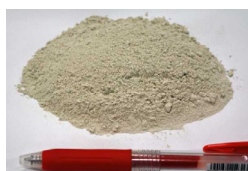
(a)多孔質ケイ酸カルシウム ( D_{50}=48\mu\text{m} )
