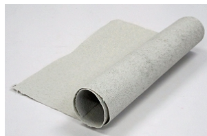
(d)ゼオライト機能紙 ( D<0.5\text{mm} を 250\text{g/m}^2 担持)
