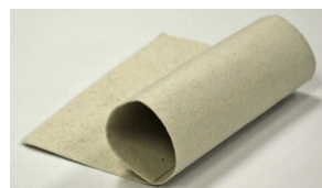
(d)ケイ酸カルシウム機能紙 ( D_{50}=182\mu\text{m} を 295\text{g/m}^2 担持)
