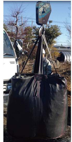
(c)ゼオライト機能紙を用いた大型土のう(直径1.1m×高さ1.1m)
