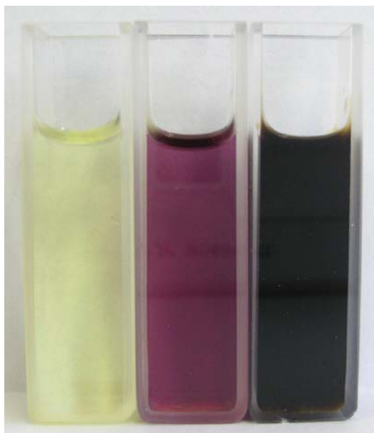
Figure 3. 光照射による溶液の色の変化. 写真左は溶液に TPB - のみを含み, 中は C 60 のみを含む. 右は C 60 と TPB - の両方を含む. 溶媒はすべて NB で, 卓上用蛍光灯による光照射が 300 分の状態である。
