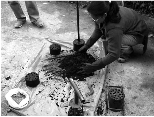
写真5. バイオブリケットの製造過程
