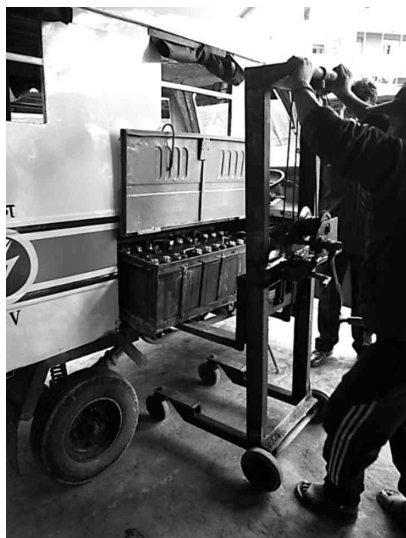
写真3. サファ・テンプーのバッテリー交換
