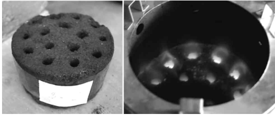
写真4. バイオブリケット (左) と燃焼の様子 (右)
