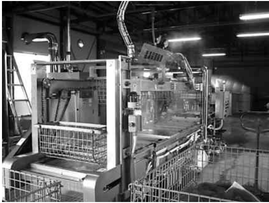
図1 鳥取県 JA 鳥取いなばに導入された I 社製全自動型の温湯消毒装置。
