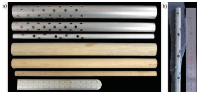
写真1 供試体に埋設した擬似根系
