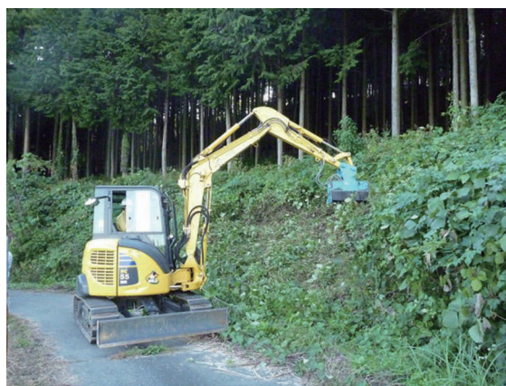
写真一 1 ミニショベル搭載油圧草刈機を用いた刈り払い作業
