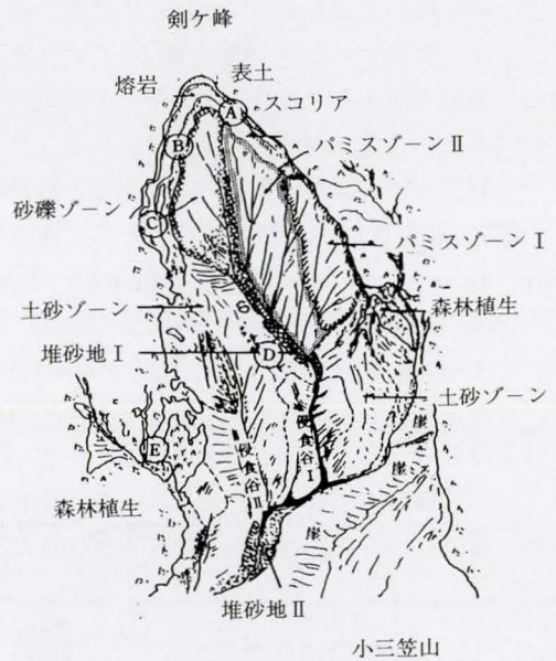
図2.2 御岳崩壊の土砂堆積状況
