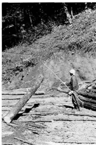
12. 自在ジャックルの留金をたたいて荷を外すところ
