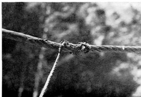
5. ストッパーに荷吊り索がかかっているところ
