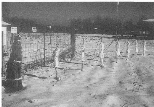
図-2 防寒資材被覆下の温度測定状況
