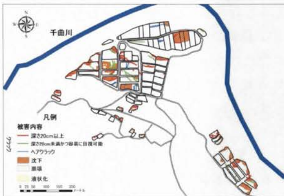
図1 小滝地区の農地被災状況 (2011年6月)
