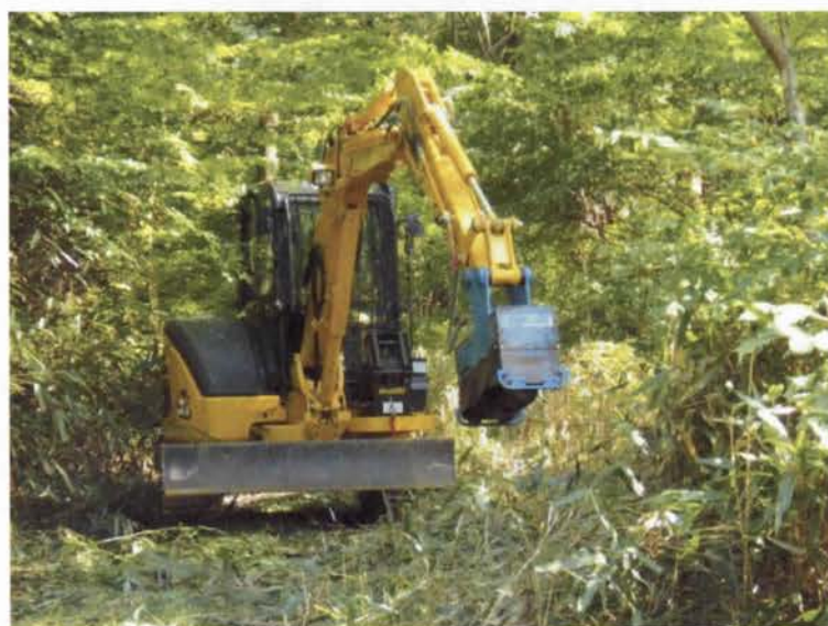
写真1 ミニショベル用搭載型油圧草刈機
