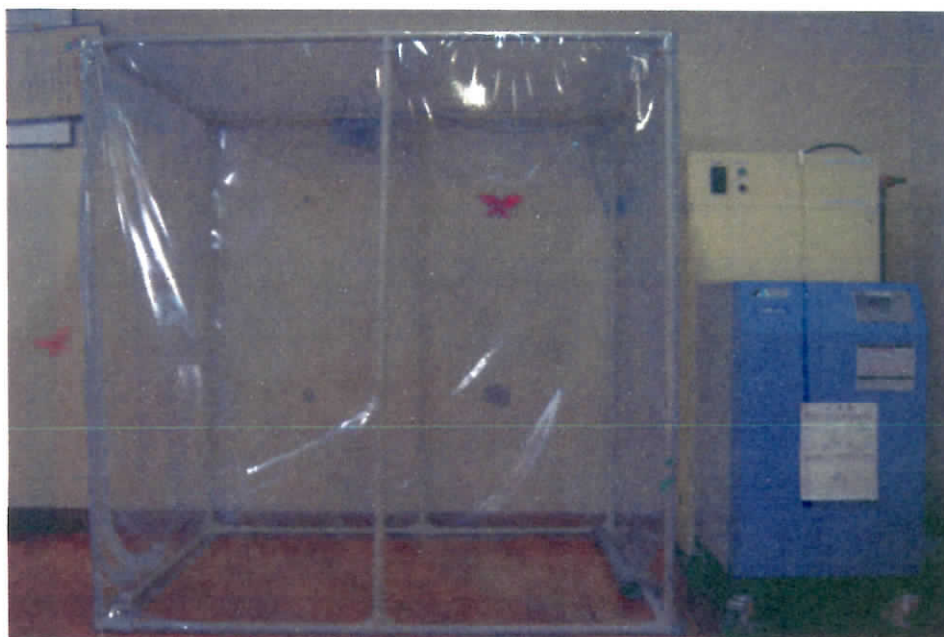
図 2.3 常圧低酸素・高酸素室（1.9m×1.3m×1.6m，容積 4.0m 3 ） および低酸素・高酸素発生装置
