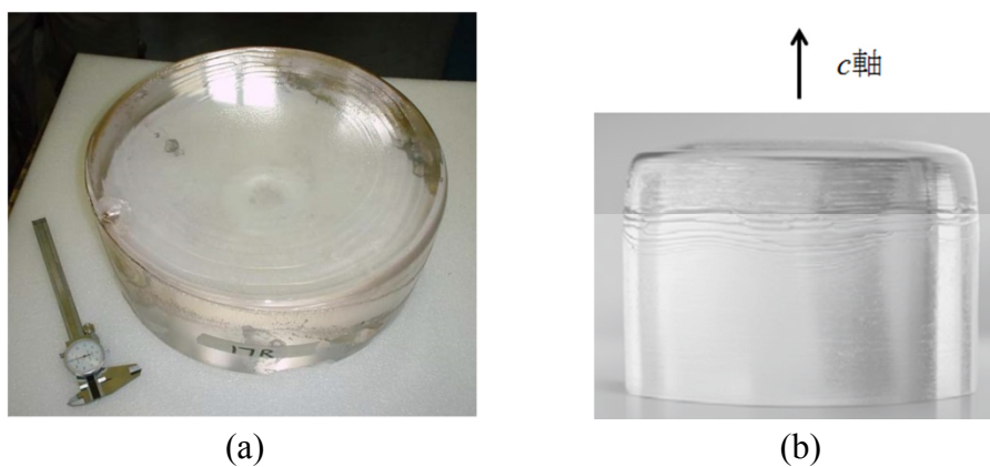
図2-9 (a) HE 法で育成した直径340mm で重さ 65kg のサファイアブール 23) と(b) CHES 法で育成した c 軸方位の直径 260mm のサファイアブール 24)
