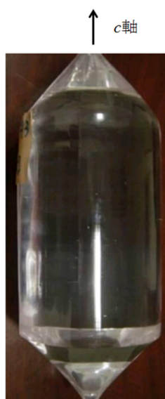
図 2-11 CZ 法で育成した c 軸方位で直径 4-inch のサファイア 21)
