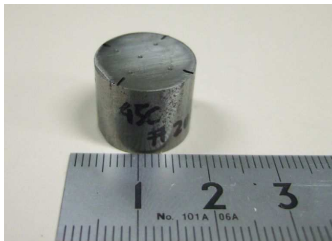
図 2. 1 2 S45C 試験片 研磨紙#2000 による表面研磨
