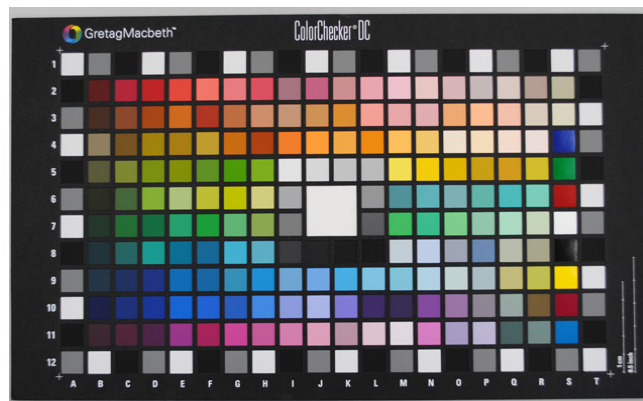
図 6.7 分光反射率とカメラ出力との関係をデータベース化するためのカラーチャート
