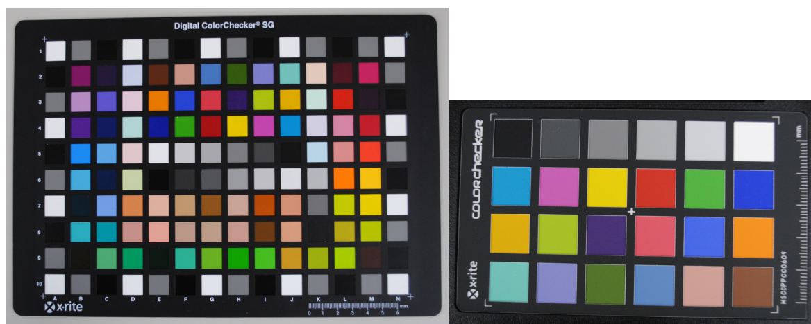
図 3.7 基準カメラの較正に用いたカラーチャート（左）と未較正カメラの色変換に用いたカラーチャート（右）
