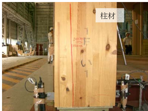
写真 3.4.1-1 柱材の割れ
