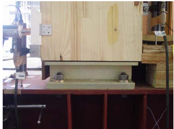
写真3.2.1-4 柱脚接合部
