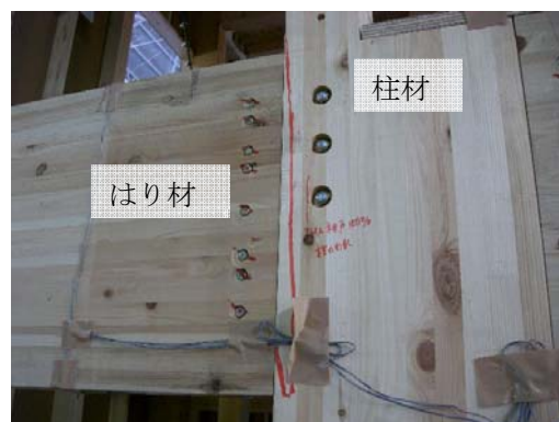
写真 3.4.1-4 柱材の割れ（柱はり接合部）
