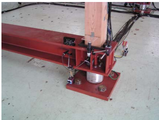
写真5.2.3-1 柱脚接合部
