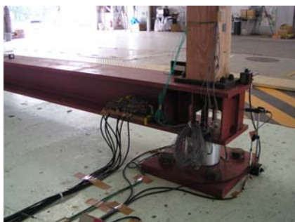
写真5.3.2-1 ロードセル (木フレーム)
