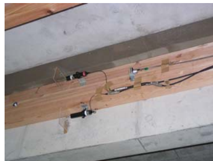
写真5.3.2-4 変位計 (水平構面-RC ずれ)
