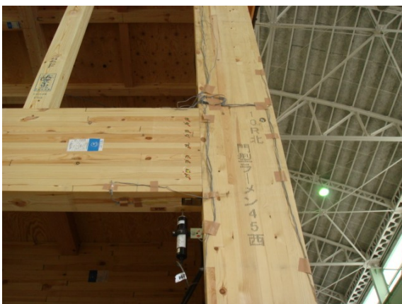
写真3.2.1-5 柱 - はり接合部 (T型)
