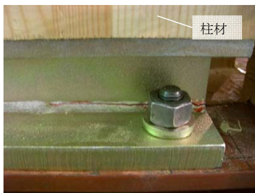
写真 3.4.1-3 柱脚接合部の割裂
