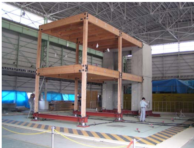
写真 5.2.1 試験体全景（上：木床試験体、中：RC床試験体、下：2層試験体）
