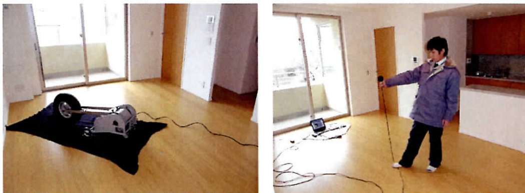
図 2-22 床衝撃音遮断性能測定状況写真 (左：音源室，右：受音室)
