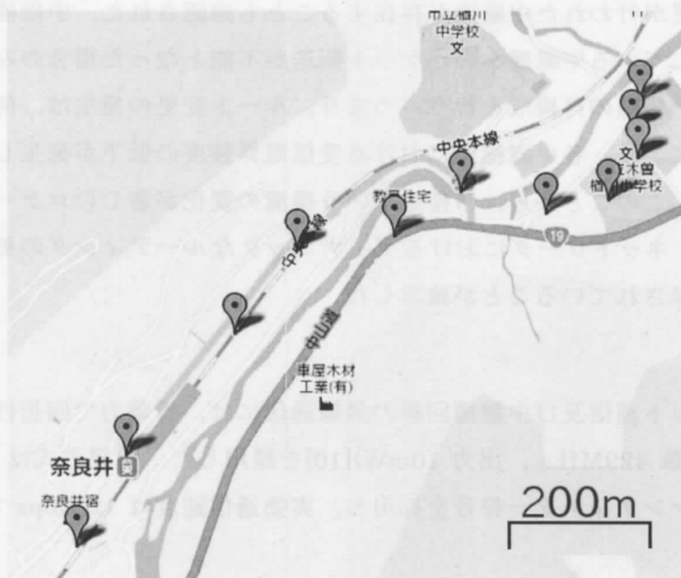
図 2.8. 山間地における中継機配置状況
