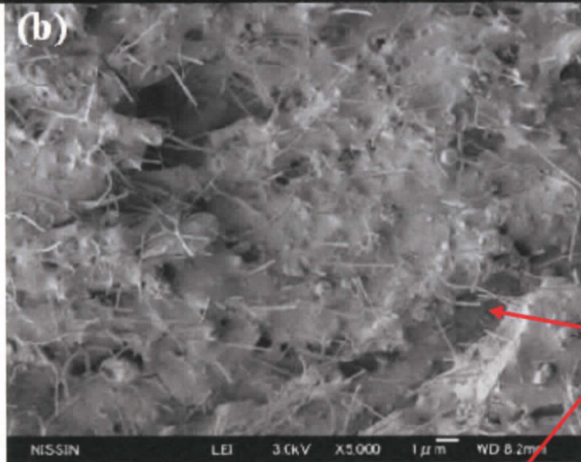
図(b) 3 wt% MWCNT-1/FKM 複合材の引張断面の 5000 倍 SEM イメージ. 長い CNT が観察され, 接着不良を生じている.
