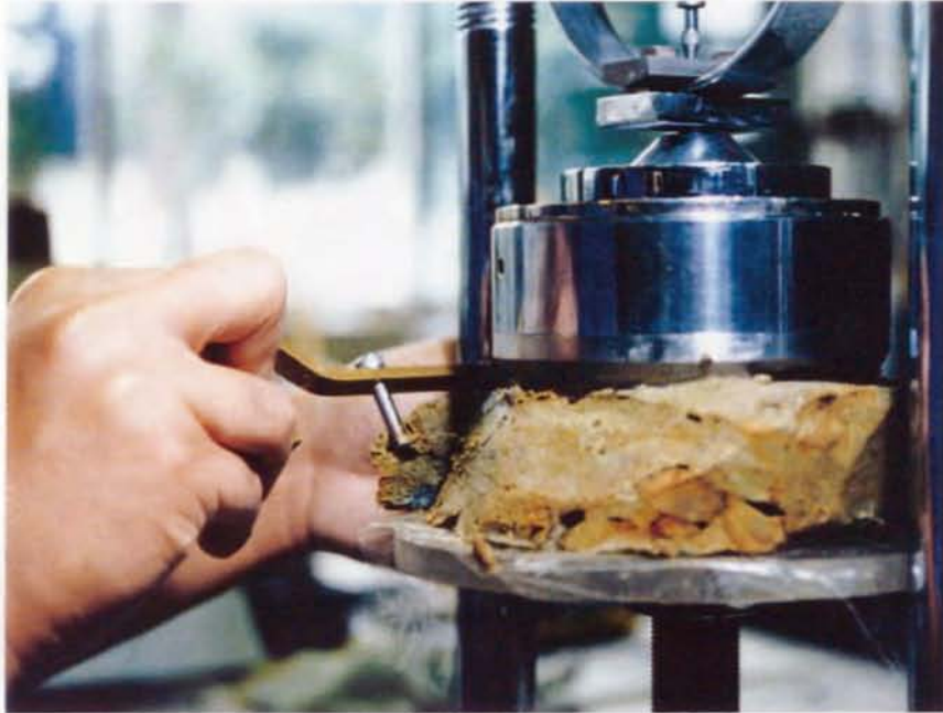
写真-3 外側部分の成形
