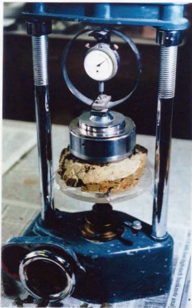
写真-2 試料をカッターリングへ挿入 (試料をカッターリングに対して垂直に、昇降台を用いて徐々に、押し込んでいく)
