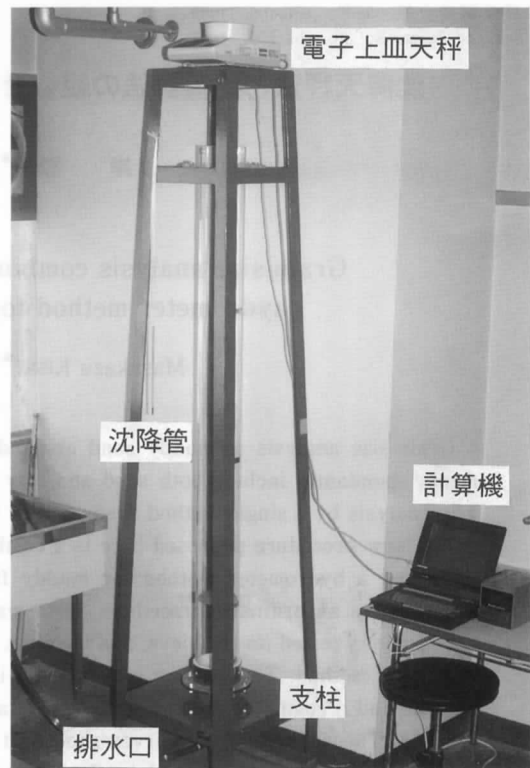
第1図 沈降天秤法の粒度分析システム。
