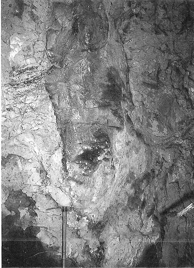
写真図版Ⅳ 大杭層上部中に発達する低角の逆断層，節理。地層はハンマーの柄と同じ方向でほぼ垂直に近い。やや黒みがかったシルト層が低角の逆断層で変位しているのが分かる。
