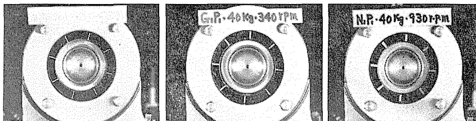
図10 静止時における 保持器の端面
