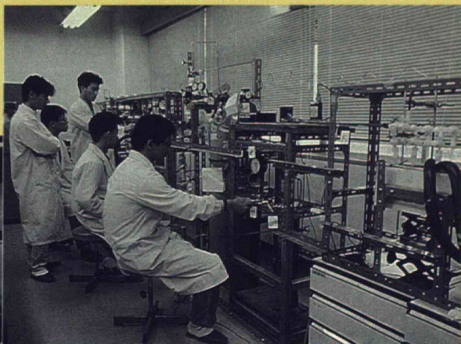
層間化合物合成装置 グラファイトの結晶間隔を種々変え、高性能な無機材料を作る合成ライン (平成2年)
