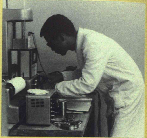
回転粘度計 絹糸の形成過程を溶液粘度から解析するため大活躍した Hercules High Shear Viscometer (昭和41年当時)
