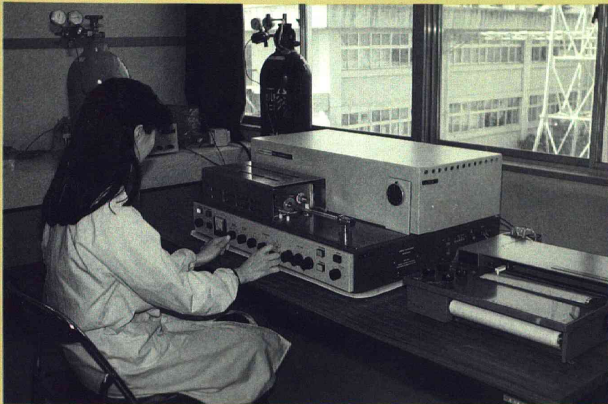
元素分析装置 合成した物質を燃焼しその物質に含まれる元素の組成を測定する
