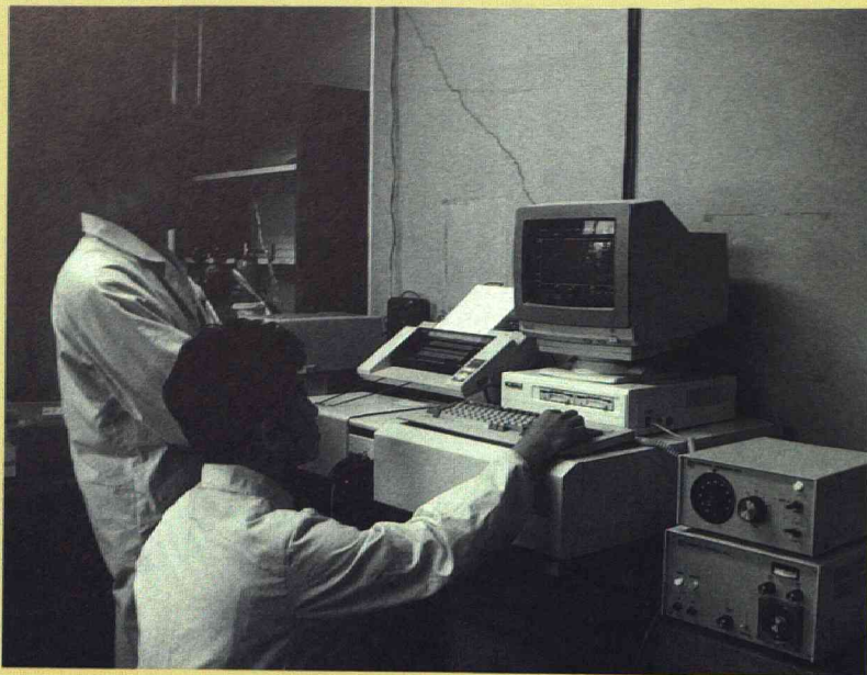
紫外・可視分光光度計 染色実験、錯体形成物、ヨウ素呈色などの研究に威力を発揮
