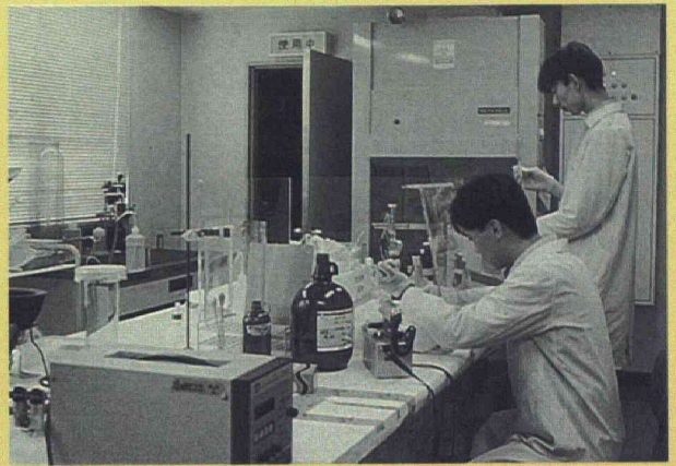
生命工学実験実習棟・P2R1実験室 放射性同位元素で標識した遺伝子(DNA)を取り扱っているところ。微量な試料の分析に放射性同位元素の利用は欠かせない。管理区域の中で黄衣と手袋を着用し、アクリル遮蔽板で防爆している
