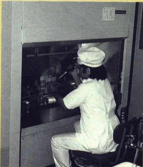
生命工学実験棟安全キャビネット ウイルスの 遺伝子操作実験
