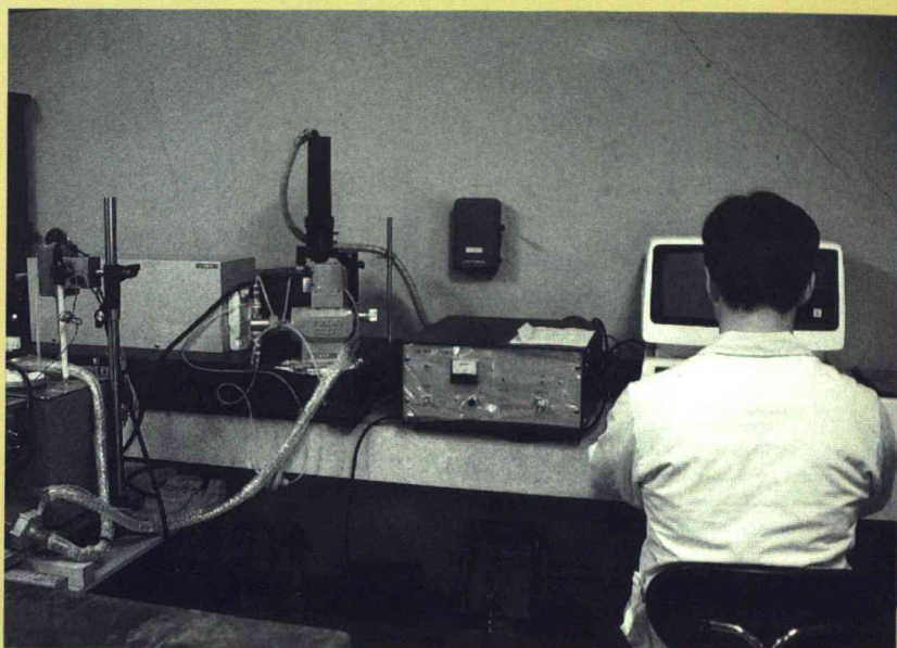
光散乱測定装置 高分子の分子量 決定ならびに高分子溶液の白濁化・ ゲル化過程の追跡に頻繁に使用
