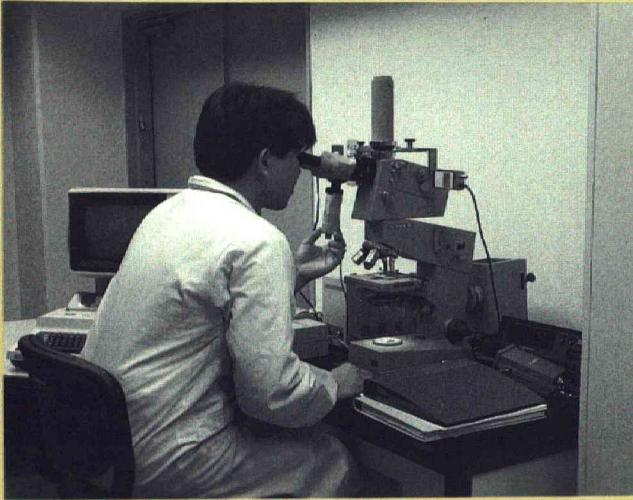
干渉顕微鏡 材料の屈折率分布 または厚さ分布の計測
