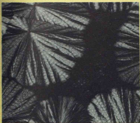
無機高分子の球晶 ポリ(ビス( \beta -フェノキシエトキシ)フォスファゼン)の融液(160°C)を60°Cに30時間放置して得られた球晶(偏光顕微鏡下)
