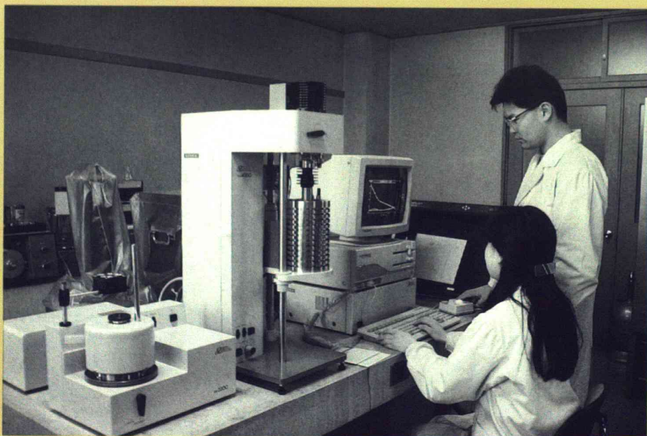
熱機械分析装置 力学的性質 と熱的性質を同時チャンネル で測定できる装置。学科改組 で平成2年に購入
