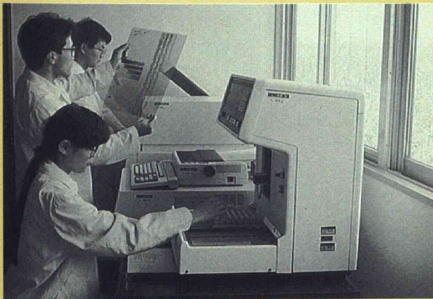
生命工学実験実習棟・R1実験室 放射性同位元素で標識した生体物質の分析。手前はオートガンマウェル、奥が液体シンチレーションカウンター、中央に見えるフィルムは遺伝子(DNA)の塩基配列を決めるためのX線写真である。遺伝子に書かれた情報の解読が行なわれている。
