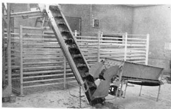
送り出しホッパー及びバケツトコンベヤー
