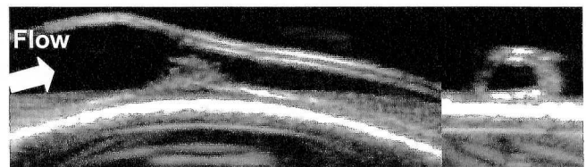
曲率をもつ狭窄モデルの超音波映像 (右：縦断面映像，左：狭窄部後流の横断面映像)
