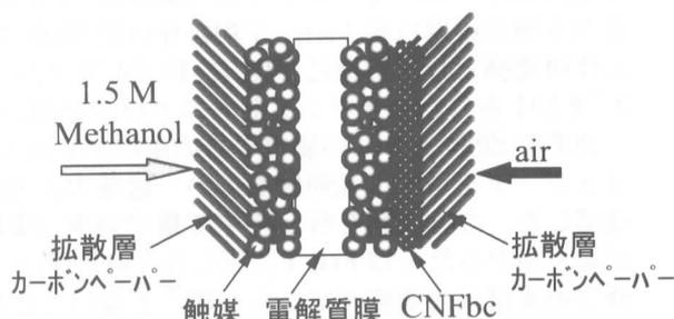
Fig.2. カーボンナノファブリック (CNFbc) を用いた DMFC の構造
