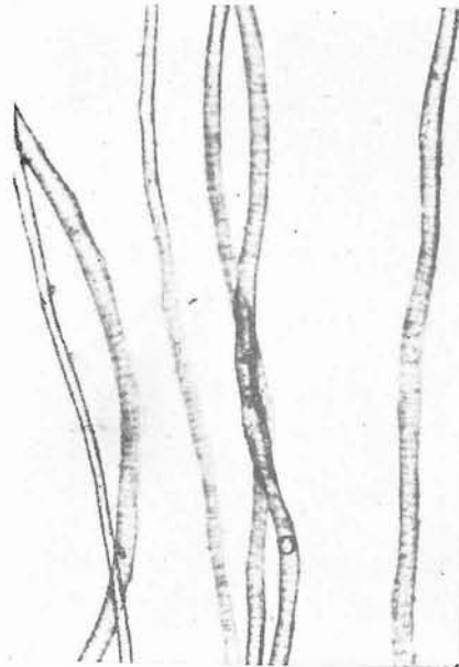
第二圖 最後の處理を終はりたる絹纖維にして著しく曲折を増加し且つ太さも増加す。
