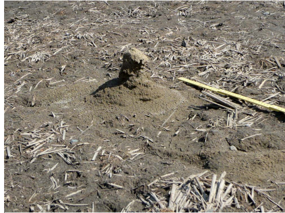
写真21 水田に生じた円柱状の噴砂丘 (月岡地区)
