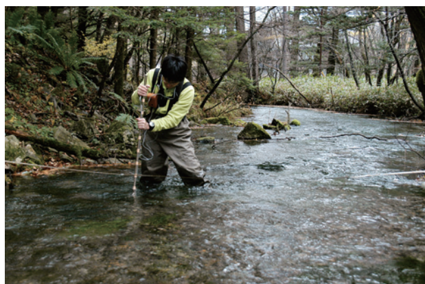
写真3 流量調査風景。源流部（写真2）からわずか下流30 mの地点で、すでに671リットル/秒の流量を示す。
