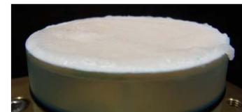
写真-4 試験前後の吸水性高分子基材
