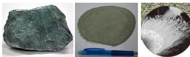
(a)モルデナイトを主成分とする天然ゼオライト (b)粒度調整後(粒径0.5mm以下) (c)電子顕微鏡写真 4), 5)
