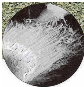
写真-2 天然ゼオライトの電子顕微鏡写真 4)
