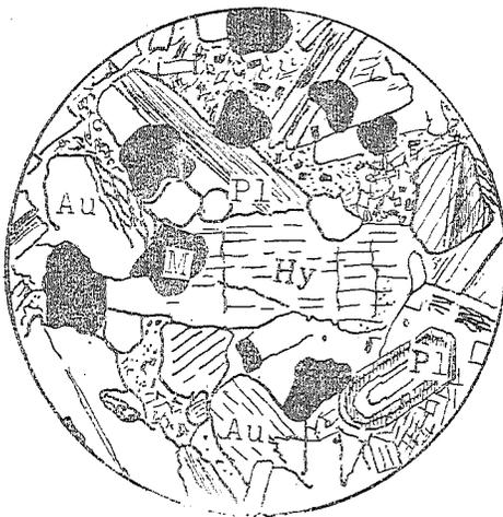
べたものと全く同質で、上部熔岩と考えられるものに属する。又後述する石地蔵の頭は検鏡の結果(第3図) quartz & olivine-bearing-hypersthene augite-andesite で美ヶ原の下部熔岩であることがわかった。即ち恐らく山麓に於て作製され、持ち上げられたものであろう。岩石学的特徴としては、この種の岩石は一般的なもので magnetite の量も従来のそれと比べて変る所はない。
