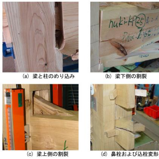
写真 3.3.1 伝統的構法による接合部の破壊形態
