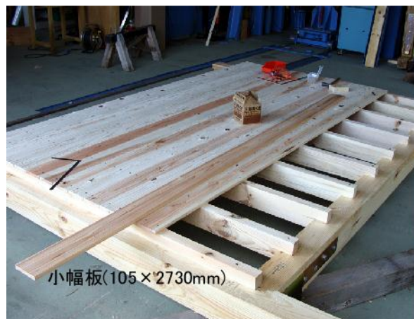
写真 4.1.3 面材料として用いた小幅板
