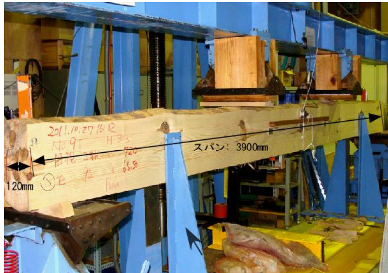
図 3.1.1 アカマツたいこ材の静的曲げ試験.
