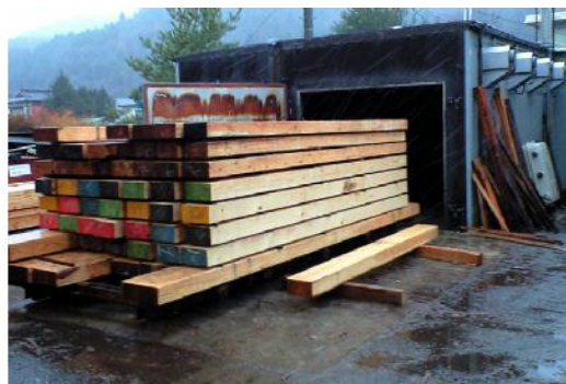
図 3.2.1 アカマツ平角材の高温乾燥状況
