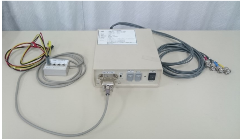
図 1-6. 筋電アンプ（特注，エム・イー社製）
