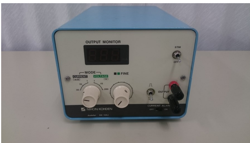
図 1-5. アイソレータ (SS-104J, 日本光電社製)
