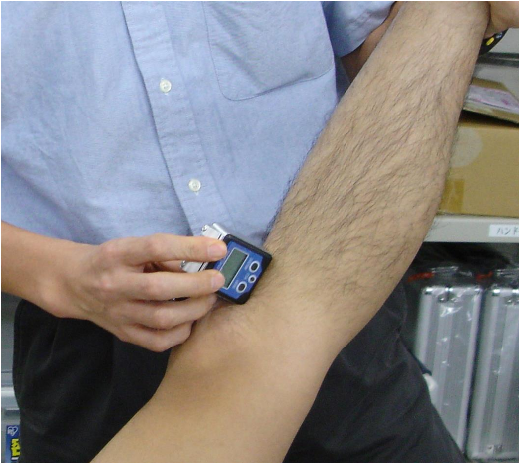
図 2-2 デジタルレベル角度計 (NJ-1, 佐藤商事社製)
