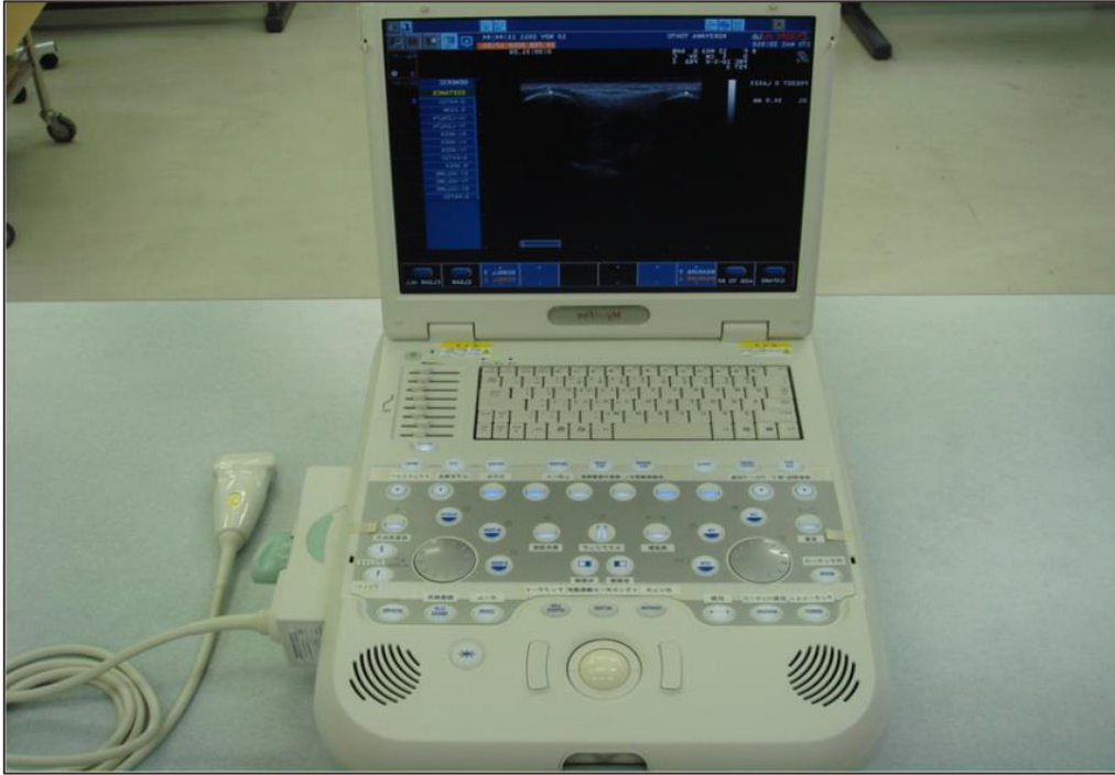
図 4-2 デジタル超音波診断装置 (MyLab25: 日立メディコ社製)
