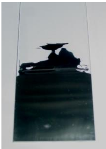
図 2-7 ガラス基板上に作製した無電解 ニッケルーリンめっき皮膜
