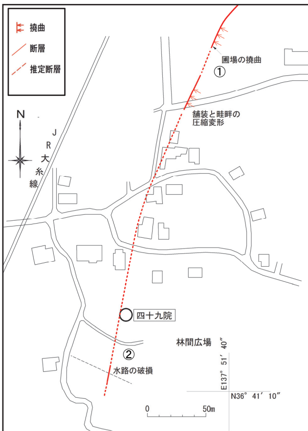
図23 四十九院周辺の断層に伴う変状
