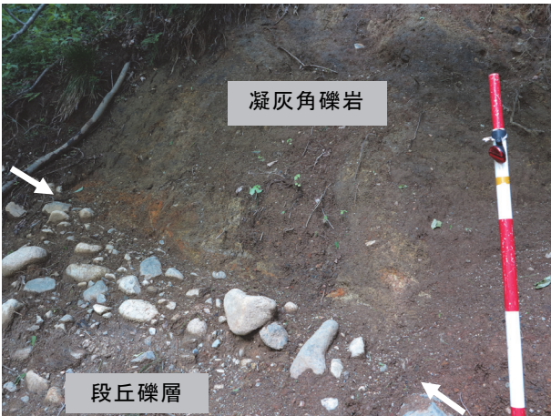
図8 城山南側の崩壊地に露頭した段丘礫層に 衝上する凝灰角礫岩 (断層は矢印の位置, 地点②)
