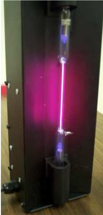
図2 高電圧電源装置と水素スペクトル管 カラー写真でみると、水素ガスが赤ピンク色に発光しているのがわかる。
