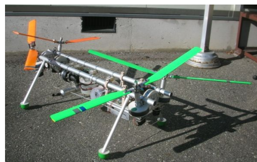
図7 交差反転式4発ロータヘリコプタ
