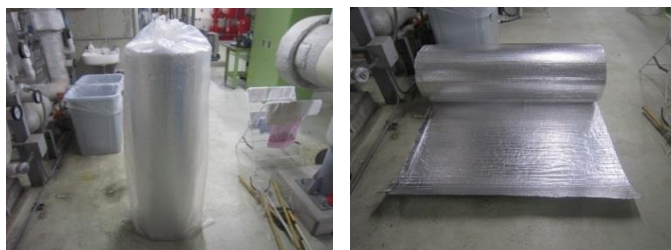
写真 5-6 両面アルミ反射シート
